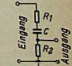
Bild 6. Schaltung und Berechnungsunterlagen für ein Filter zur Dämpfung der Bässe
