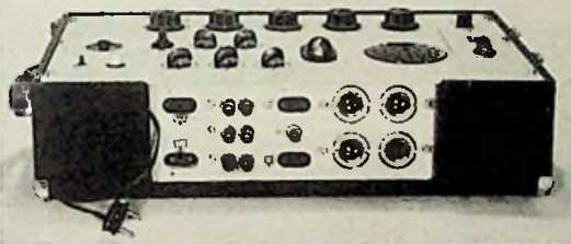
Bild 1. Das Reise-Mischpult Ela V 504 bei abgenommenem Deckel (Telefunken)
